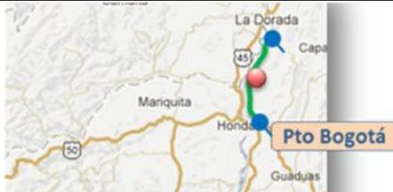
La unidad funcional No. 5 correspondiente al tramo Puerto Bogotá– intersección puente tiene una longitud de 27 km y se tiene previsto un alcance de mejoramiento de la vía existente. En este tramo se prevé una intersección a desnivel que conecta el tramo Puerto Bogotá– Puerto Salgar con la vía Honda-Villeta-Manizales.
