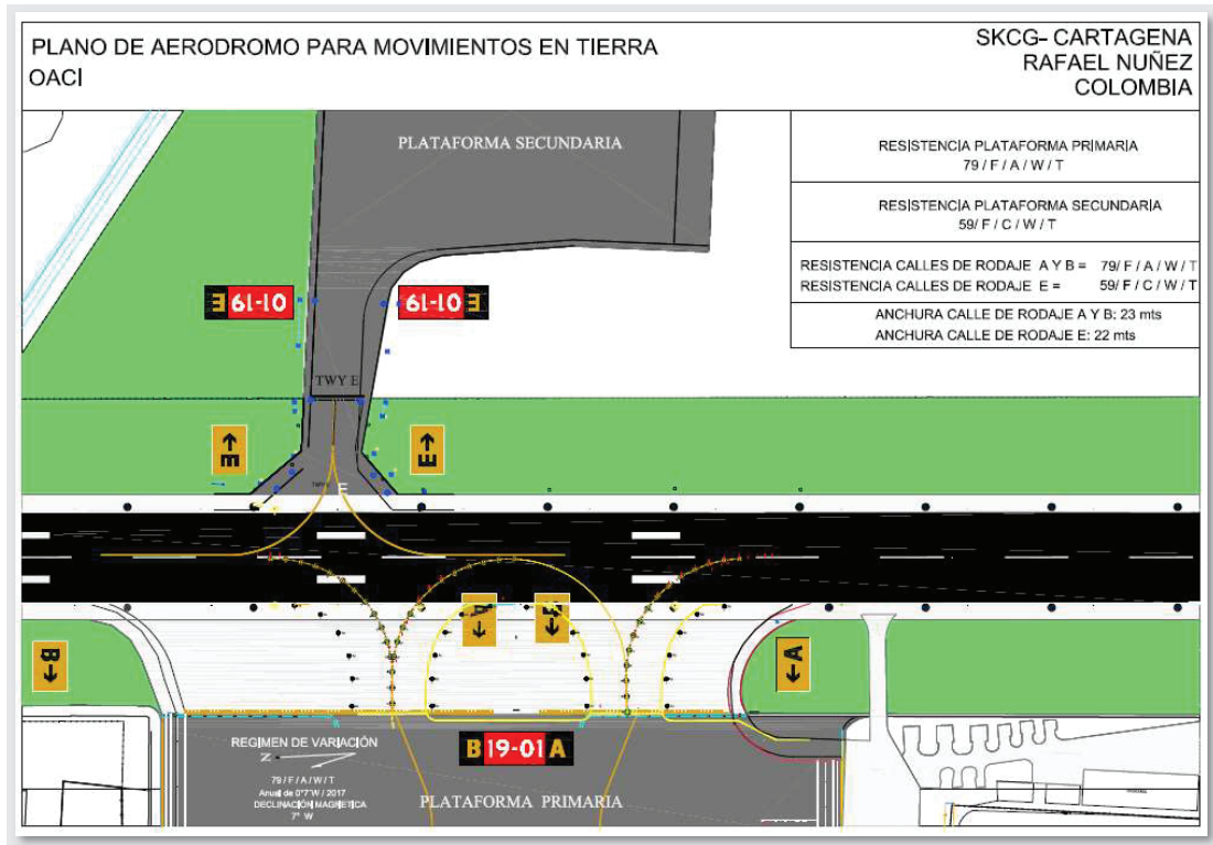
Ilustración 3: AIP Colombia. SKCG – Plano de Aeródromo para Movimientos en Tierra. OACI
