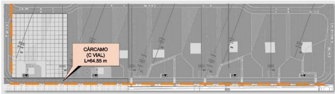
Ilustración 63. Drenaje Plataforma Principal (II)
