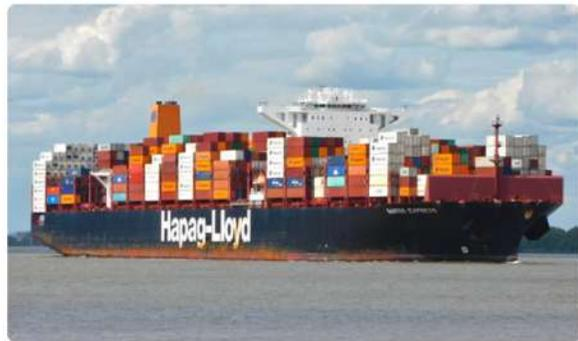
Para este caso el puerto se expone a una **altura del barco de 53.5 metros**, equivalente al resultado de restar el calado de la altura del barco (*airdraft*), superior al de las grúas G21, G22 y G23 (38 mts).
