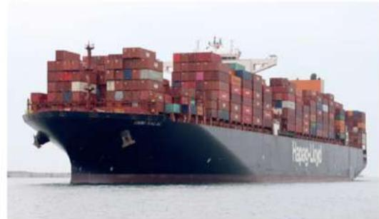
Para este caso en particular, el barco exige un *airdraft* de **52.76 metros**, equivalente al resultado de restar el calado de la altura del barco. En adición, la manga máxima de 51.2 también supera la capacidad actual de las grúas (*maximum out reach*) de 51 metros.
