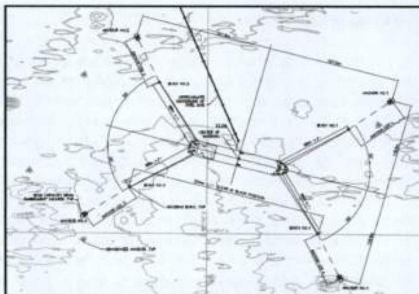
Ilustración 8. Esquema del sistema Multiboyas – Alternativa No.6
