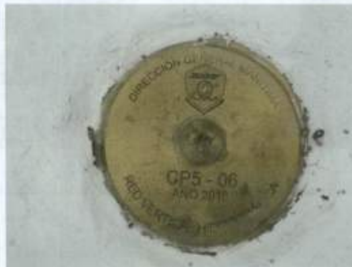
FIG 2-29. PUNTO GEODESICO SECUNDARIO PARA CALIBRACION DEL GPS
