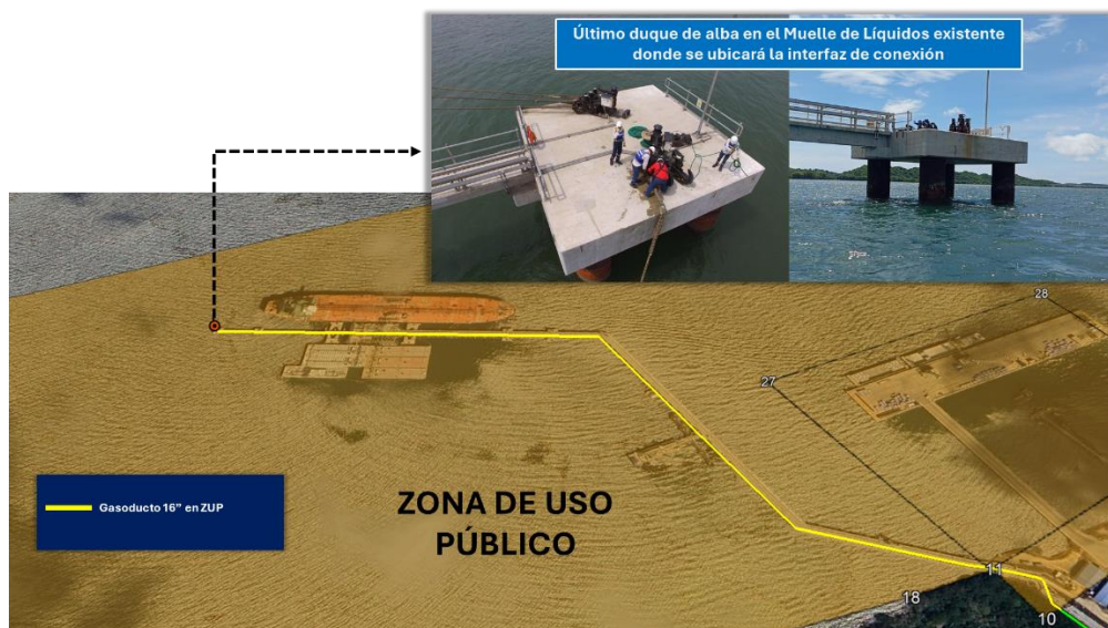
Ilustración 13 – Gasoducto sobre el muelle.
