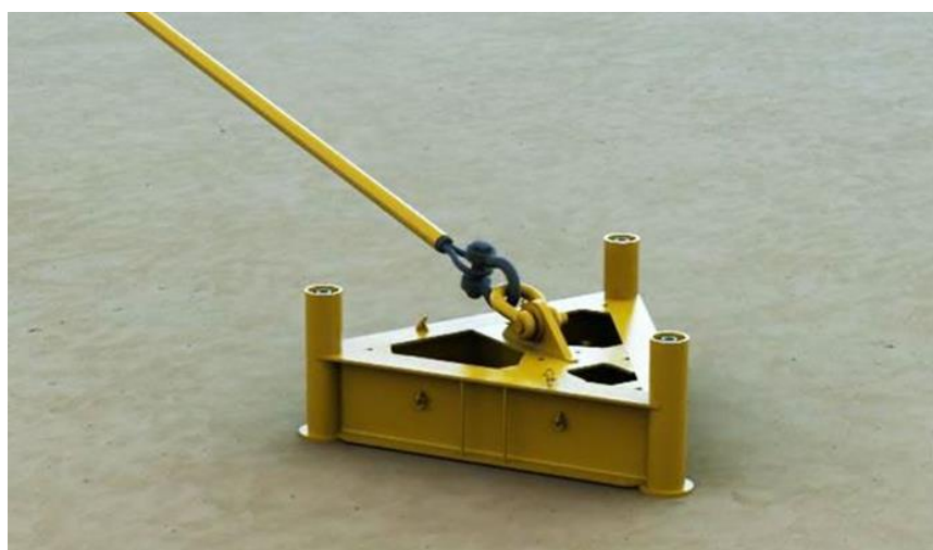
Ilustración 9 - Esquema de referencia de platina de amarre con micropilotes (vista sobre el lecho marino)
