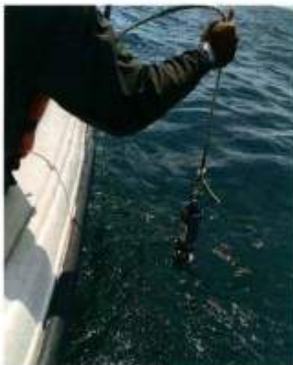
Imagen 7. Toma de datos con Perfilador de Velocidad del Sonido (SVP).
