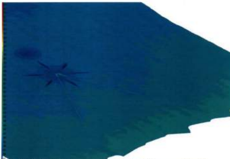
Ilustración 13. Tuberías y zanjas en zona de PLEM con ecosonda multihaz.
