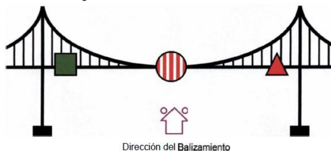
Ilustración 3: Esquema Señalización Diurna Puente - Vista Lateral
