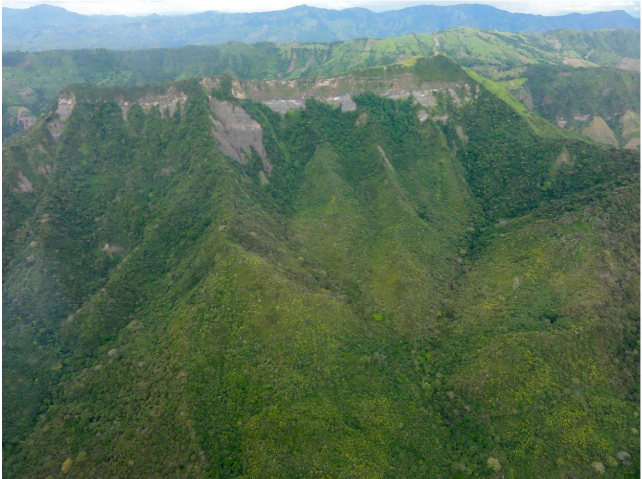
Figura 53. Se observan las capas estratigráficas horizontales y los materiales de grano fino altamente meteorizados, los cuales representan la geología típica del área del Proyecto.
