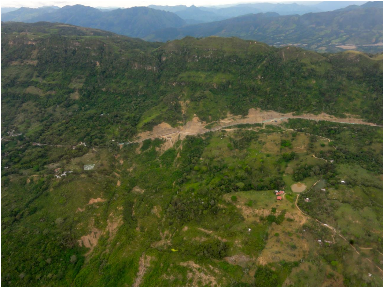
Figura 55. En esta fotografía, capas estratigráficas horizontales son visibles en la cima de la montaña en el centro de la imagen. Abajo se ven los escarpes del Deslizamiento de La Mona, sucedido en Abril de 2011.
