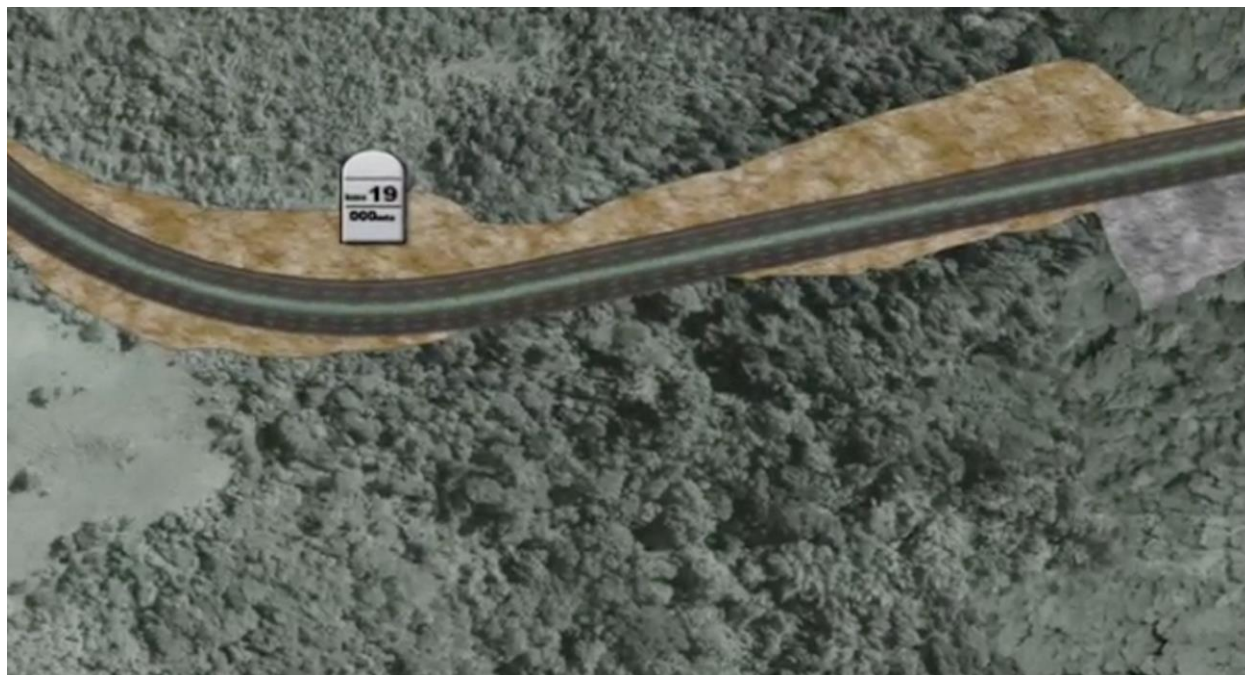
Figura 38. El trazado del Tramo 1, cerca al K18+700 [301] presenta un corte alto sobre el Deslizamiento de San Francisco, al costado derecho de la imagen y continúa sobre la Reserva Nacional Natural San Francisco. El corte tendrá aproximadamente 68 metros de alto con una pendiente máxima de 2.3:1 V:H).
