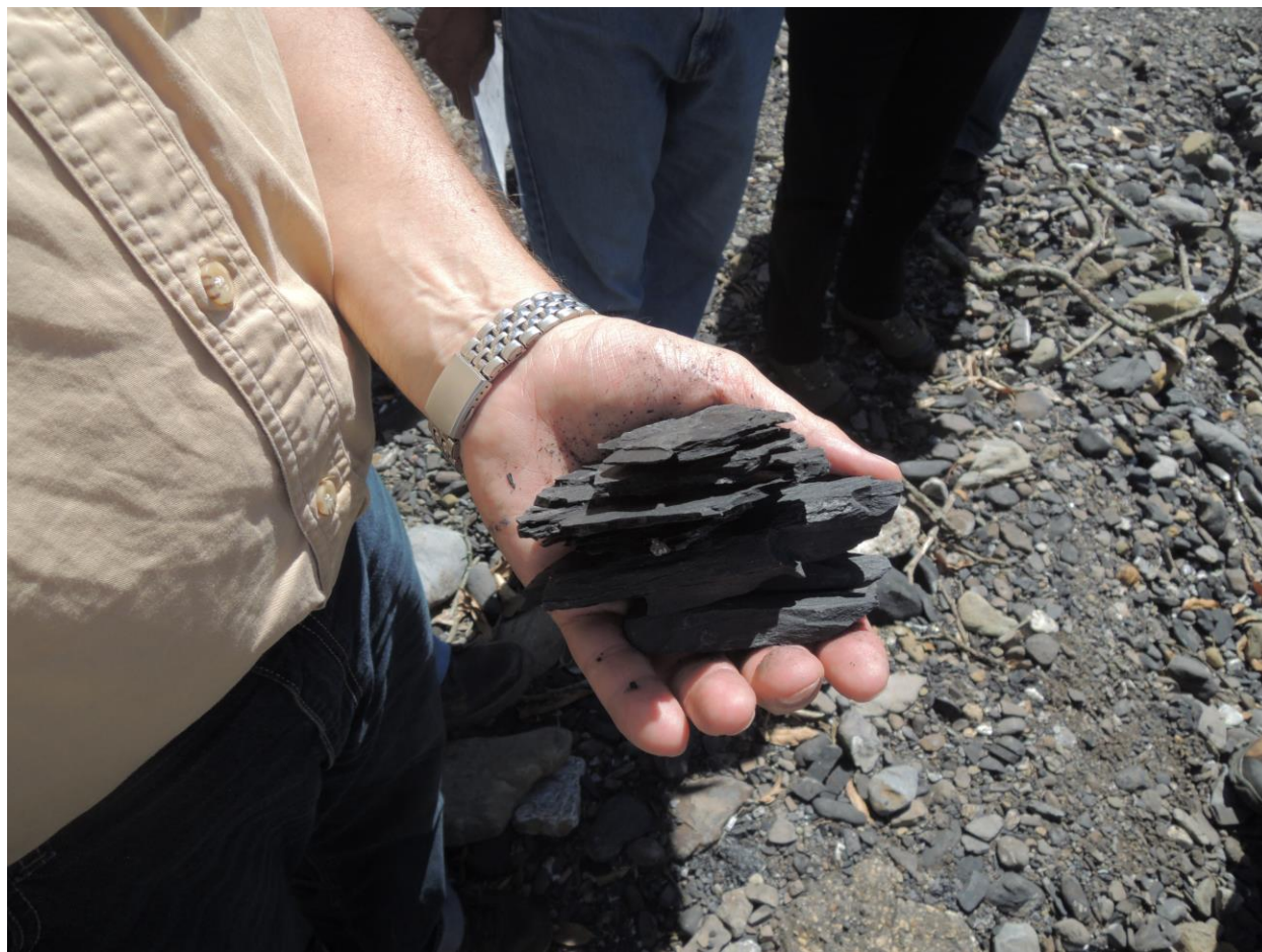
Figura 10. Lutitas altamente meteorizadas de la formación Trincheras, muestra de cómo se desintegran fácilmente en la mano. Este material es común en la Parada 3 y es prevalente durante gran parte de la alineación del Tramo 1.
