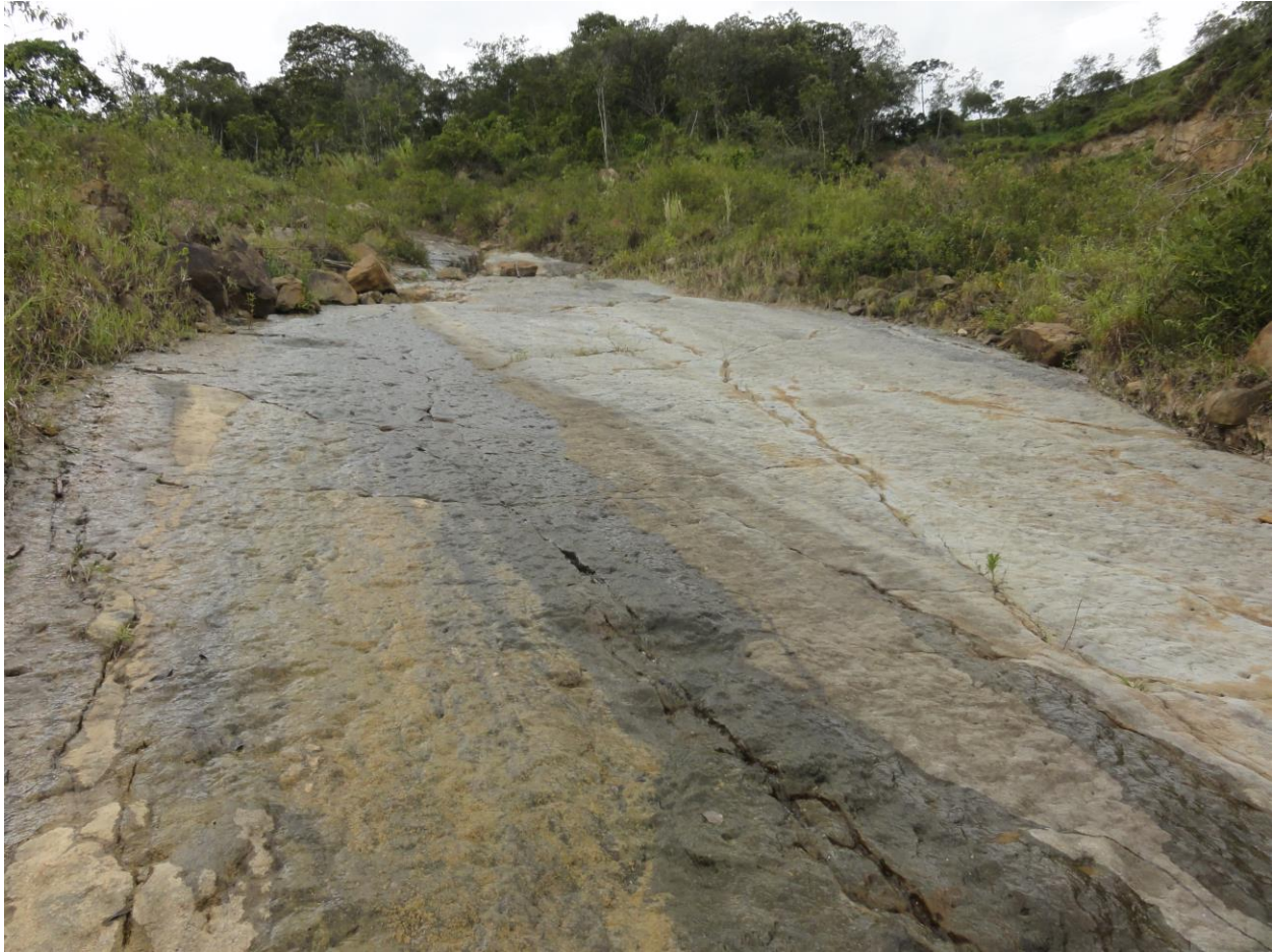
Figura 42. Vista de una capa de areniscas sublíticas de la Formación San Juan de Río Seco en el Deslizamiento de San Francisco. Tres ramales del Río San Francisco desaparecieron con el deslizamiento, aunque dos han reaparecido. Se observa agua hacia debajo de la pendiente en la capa de arenisca.
