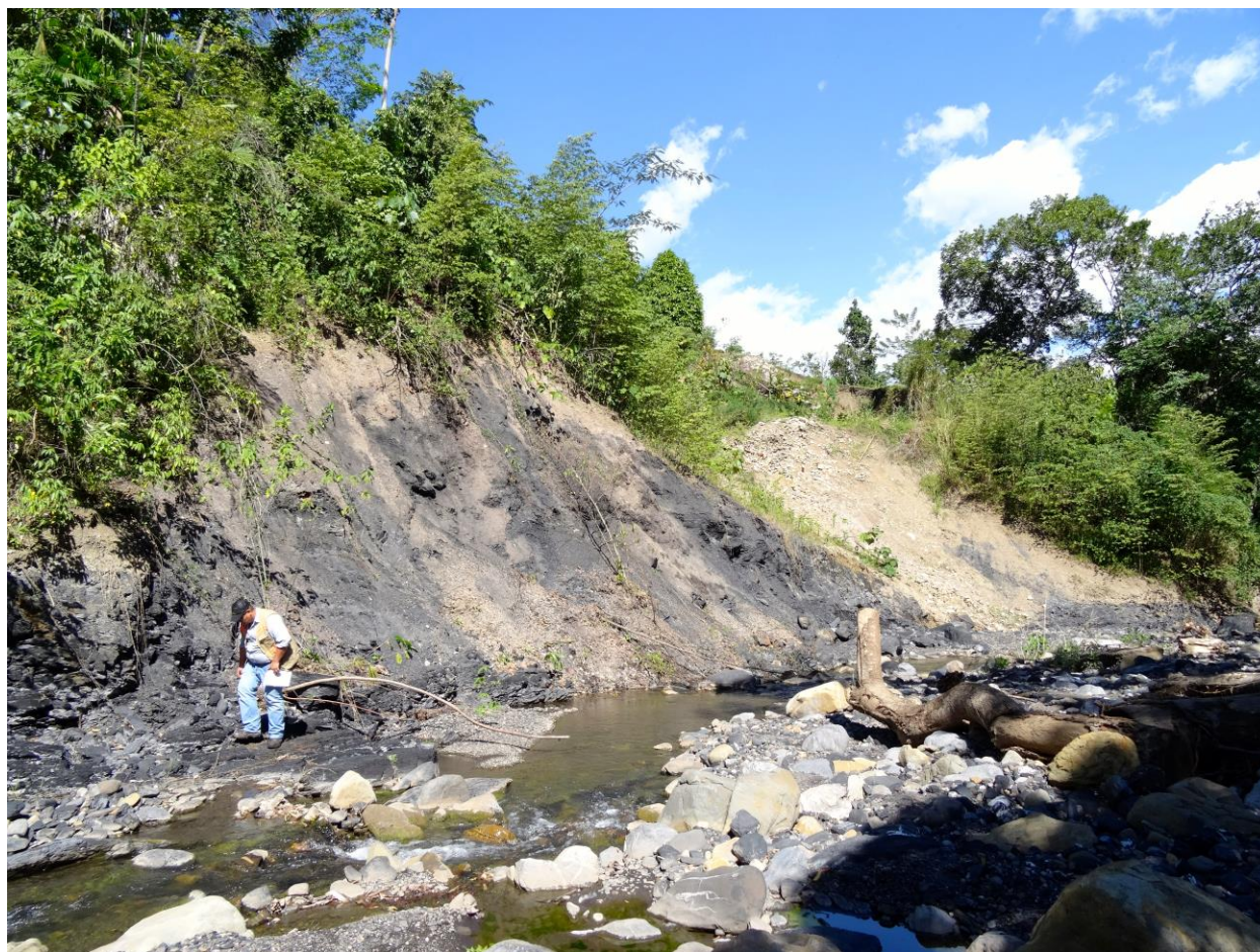
Figura 12. Deslizamientos de tierra en la Quebrada El Cune, materiales meteorizados de la Formación Trincheras en la parada 4.
