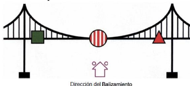
Ilustración 3: Esquema Señalización Diurna Puente - Vista Lateral
