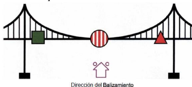
Ilustración 3: Esquema Señalización Diurna Puente - Vista Lateral
