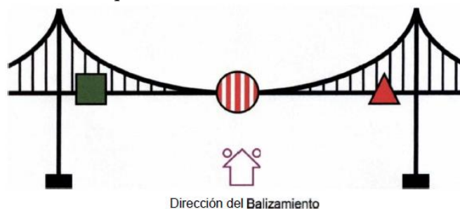
Ilustración 3: Esquema Señalización Diurna Puente - Vista Lateral
