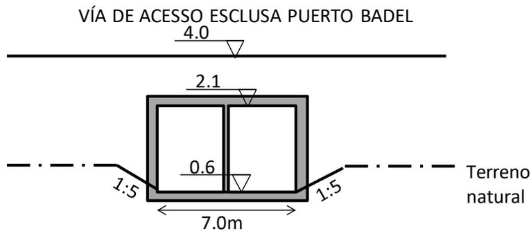
**Figura 2-32 Sección longitudinal de la rebose de la obra G2d (fin del caño de Lomas de Matunilla)**
