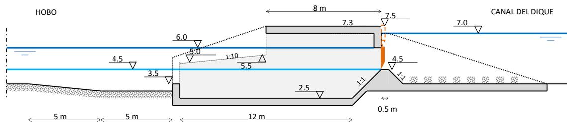
El paso para peces en B1 (entre la alcantarilla de cajón y el Canal del Dique) consistirá en mínimo 44 pasos, construida con tablestacas. La idea básica del diseño es minimizar el caudal a través de estos
