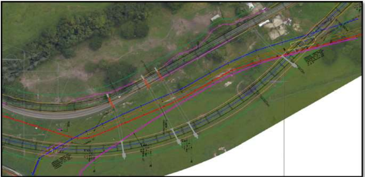
Ilustración 4 paralelismo con calzada (Solución por corrección de trazado geométrico vial)
