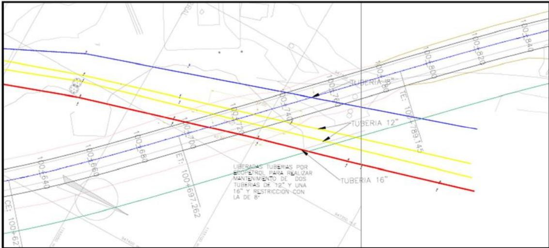
(iii) Cruce enterrado: Son los cruces que se proyectan entre la vía y la tubería, en el cual, la tubería queda debajo de la vía.
