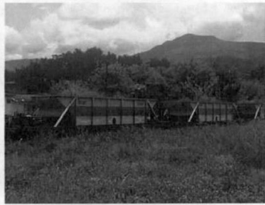
Foto 20. Tolvas balasteras estacionadas sobre la vía férrea.
