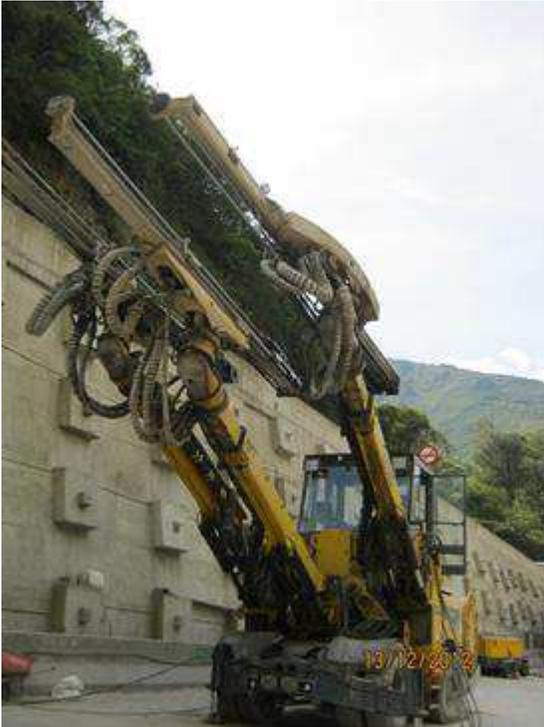
Equipos de preformación de agujeros conocida a nivel mundial como “Jumbos”, utilizada para la posterior utilización de materiales explosivos en los sitios donde los terrenos naturales lo permitan. El de la foto, corresponde a un Jumbo de 2 brazos articulados y que puede ser operado por UNA SOLA PERSONA
