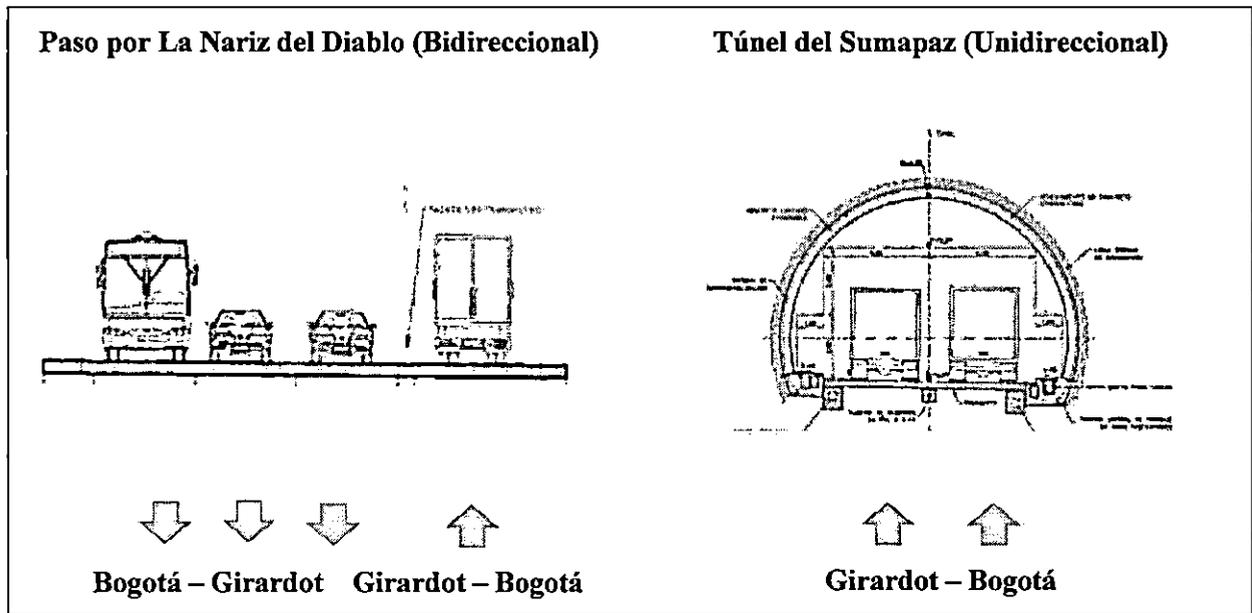
**Caso 2 de Intervención – Construcción de dos (2) carriles mediante túneles cortos por el paso de la Nariz del Diablo.**
