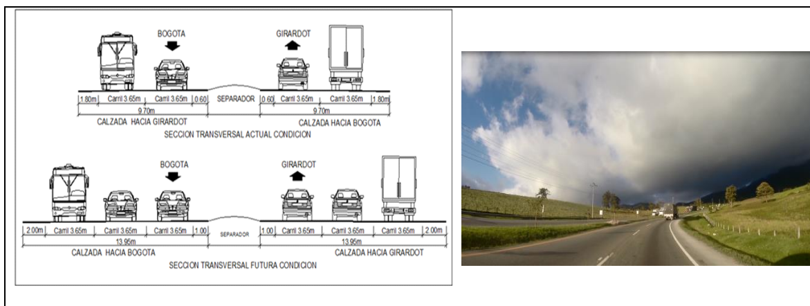
Figura 8 Vista General y Sección Transversal.
