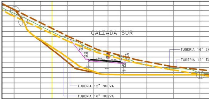
Ilustración 8 variantes verticales (DETALLE SUR)
