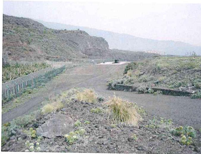
Se demolerá tanto el muro que actualmente soporta el relleno en el borde este del vial actual, como el pavimento del ramal de subida y los muretes que lo flanquean, así como la rampa que continúa a partir de la puerta de doble hoja hasta la rasante de la parcela.
