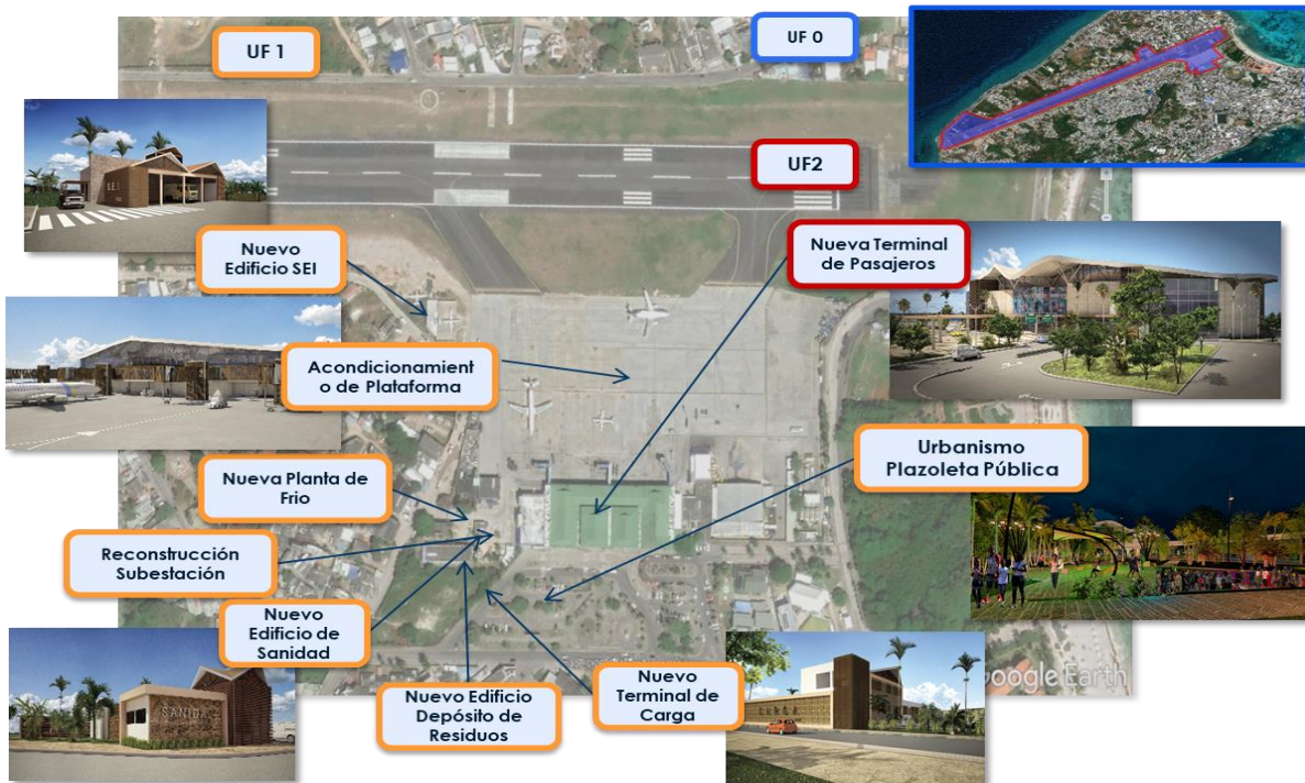
Unidades funcionales de la IP Aeropuerto Gustavo Rojas Pinilla de San Andrés
