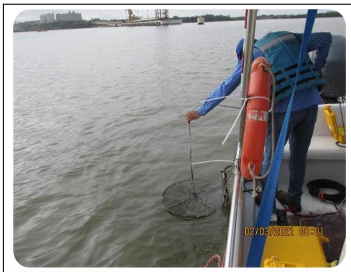
Fotos 3 y 4. Area de atraque del muelle, correspondiente al sector oriental del mismo y calibración de la ecosonda.
