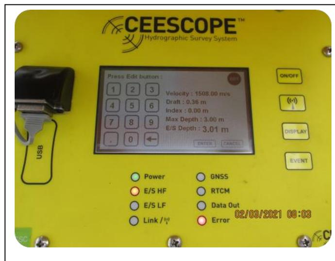
Fotos 5 y 6. Calibración de los equipos de ecosonda durante las actividades del levantamiento batimétrico.
