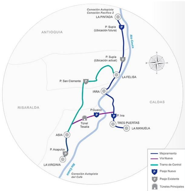
Se construirá La Variante de Tesalia, que contará con un túnel de 3,3 km, adicionalmente se construirán carriles de adelantamiento en diferentes puntos de la concesión.
